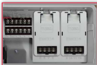
Configuration 12 voies avec 2 modules de 4 voies
