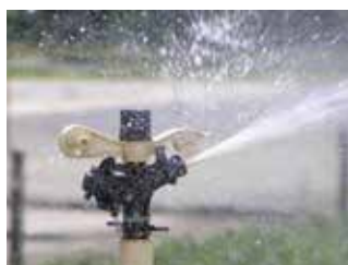
Les arroseurs à impact à cercle partiel peuvent être réglés pour s'adapter à la zone de couverture voulue.
