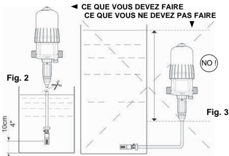
En aucun cas le niveau de la solution ne doit être au-dessus de l'entrée d'eau dans le DOSATRON (afin d'éviter tout siphonnage) (Fig. 3).
